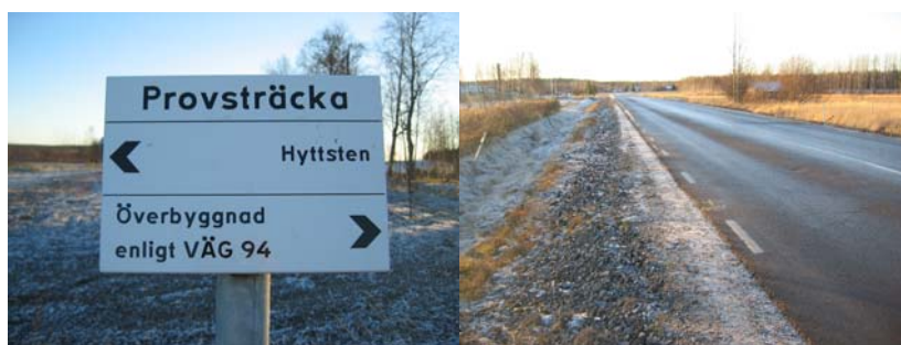
Bild 3.5 Provsträcka 2 med hyttsten.
